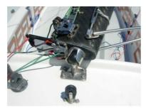
L'équipier qui se trouve dans le bateau engage le pied de mât sur son support comme indiqué ci-contre. Il exercera une légère pression vers l'avant pendant l'opération de levage ce qui évitera au pied de mât de sortir de la rotule.
