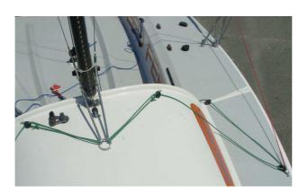
Rotation du mât. Le bout (vert sur la photo) circule en continu devant le roof.
