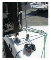
Drisse de spi (en bleu sur la photo). Elle passe entre les barres de flèche et à l'intérieur du guignol.
