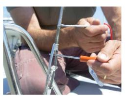
Le réglage des haubans s'effectue à l'aide d'une clé plate (6mm) et d'un petit tournevis. Important, c'est la cage de ridoir qui tourne. Pour que le mât soit parfaitement vertical, pensez à contrôler l'écart entre les axes sur les 2 haubans, par exemple avec un pied à coulisse. La tension est mesurée grâce au tensiomètre. Ce dernier est placé à environ 1.20m du pont. Pour le réglage de tension du triangle (guignol) le principe est le même.
